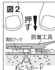
専用固定ピンの先端は石膏ボードの中で深く仕込まれております。
